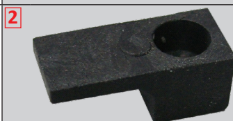
Kolbenhalterung, Verstärktes PC-ABS, Schraubmontage, für Kolben-Ø 5-6mm, max. Temperatur 90°C
